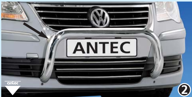
EU-pedestrian protection guard 60mm low Barre de protection des piétons CE 60 mm bas Stainless steel / Acier inoxydable 12X 4013
