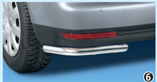
Bumper protection rear 42mm zadní chránic( 42 mm Stainless steel / nerezová ocel 12X 4033
