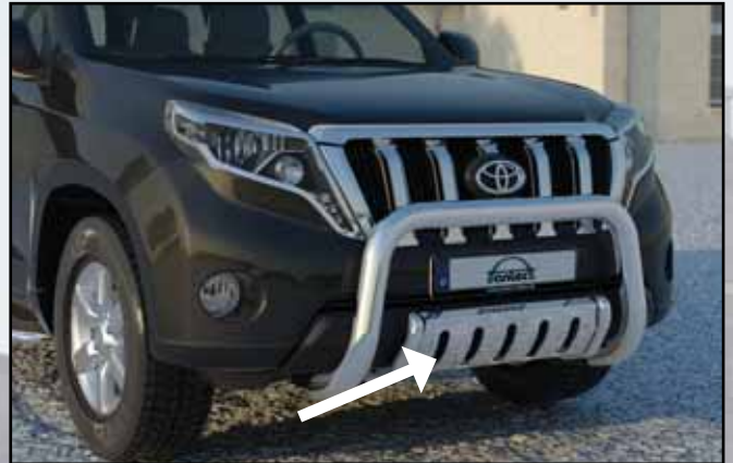
14R4014 EU underbeskyttelse Rør 42 mm, EU-rapport kun gyldig, og artikkel kan kun monteres med 14R4013 EU underride guard Tube 42 mm, EU-certificate is valid with and article only mountable with 14R4013 Edelstål / Stainless steel
