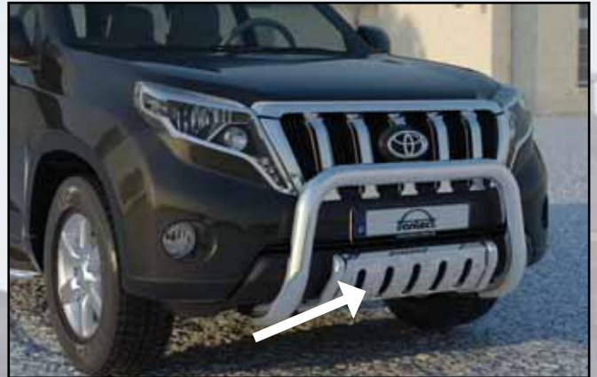
14R4014 EU-alleajoeste putki 42 mm, EU-lausunto vain voimassa ja tuote vain asennettavissa 14R4013 kanssa EU underride guard Tube 42 mm, EU-certificate is valid with and article only mountable with 14R4013 Jaloteräs / Stainless steel
