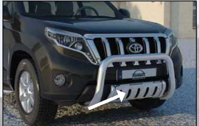
14R4014 EU underride guard Tube 42 mm, EU-certificate is valid with and article only mountable with 14R4013 EU-Unterfahrschutz Rohr 42 mm, EU-Gutachten nur gültig und Artikel nur montierbar mit 14R4013 Stainless steel / Edelstahl
