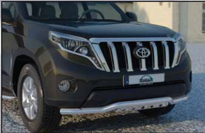
14R4017 EU-přední tvarovaný spoiler S chráničem podvozku, 60 mm EU-Spoiler protection pipe cranked with Underride protection plate, 60 mm Nerezová ocel / Stainless steel
