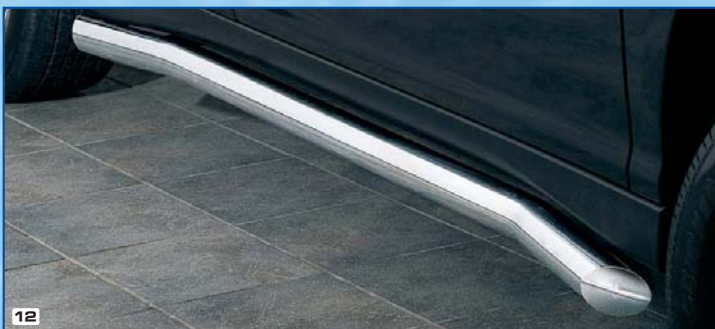
12 Side bar shaped Tubo protector de flancos doblado Stainless steel / Acero inoxidable 180 4151
