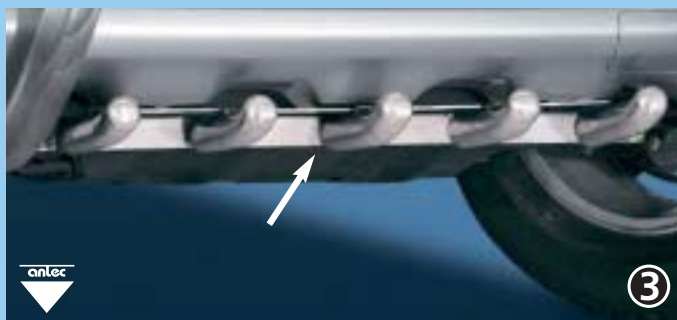
EU-underride protection front (mountable with EU-pedestrian protection guard 164 4013 only) EU-alleajoeste EU-henkilöturvakaari vain :n kanssa asennettavissa 1644013 Stainless steel / jaloteräs 164 4014
