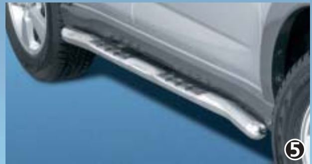
Side bar 60mm with step and rubber dots Flankenschutzrohr 60mm mit Auftritt und Antirutschnoppen Stainless steel / jaloteräs Terios Top S 164 4151 Terios, Terios Top 164 4451
