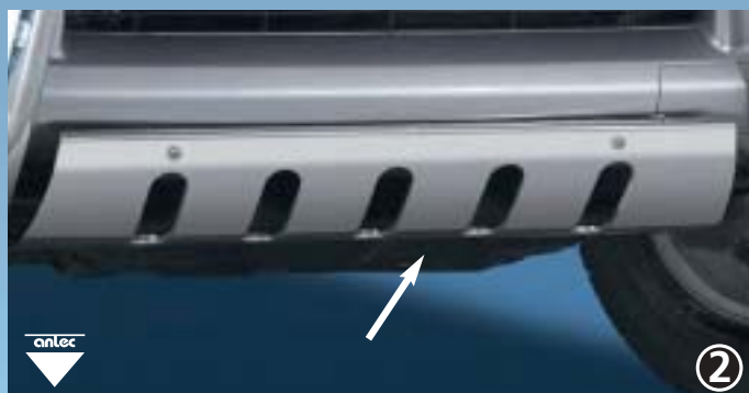
EU-underride protection plate (mountable with EU-pedestrian protection guard 164 4013 only) EU-Unterfahrschutzplatte (nur mit EU-Personenschutzbügel 164 4013 montierbar) Stainless steel/Edelstahl 164 4114
