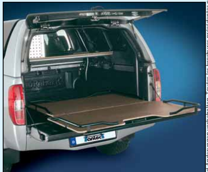
15U5790 DC (DOUBLE CAP) 15U5690 XC (SPACE CAB) Tiroir en bois résistant à l'eau collé avec garde-corps noir Drawer made of water-resistant glued wood with black railing Bois + Acier / Wood + Steel
