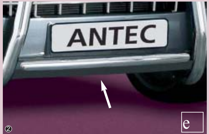
② EU Horizontal Pipe 42mm EU poprzeczka 42mm Stainless steel / stal szlachetna 151 4041
