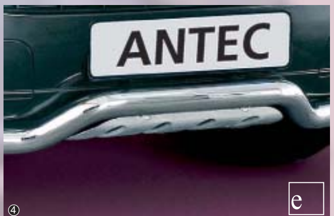
④ EU Underride Protection Plate Adaptable only in combination with Spoiler Protection UE płyta zabezpieczajaca podwozie przed najechaniem tylko do montazu z rura ochronna spoilera Stainless steel / stal szlachetna 151 4014
