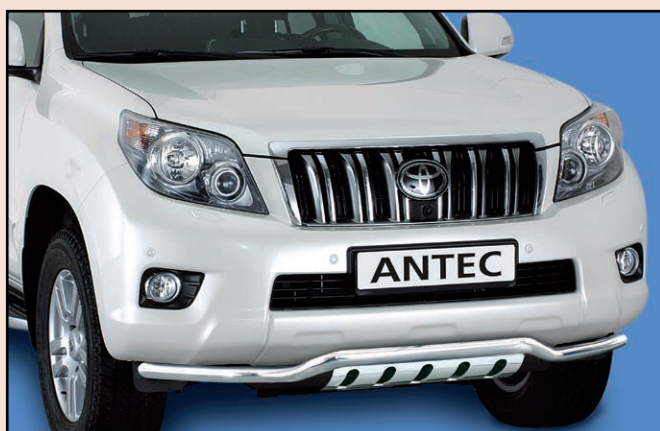
14R4017 EU-přední tvarovaný spoiler S chrání em podvozku, 60 mm EU-Spoiler protection pipe cranked with Underride protection plate, 60 mm Nerezová ocel / Stainless steel
