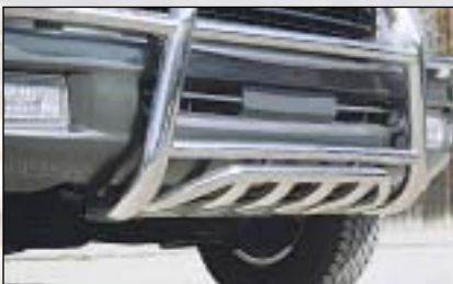
⑥ Front underride protection Bescherming voor onderbouw vooraan
