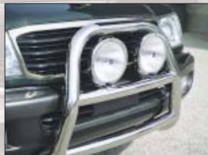
Support for additional head lights ⑧ Logement pour phares longue portée supplémentaires
