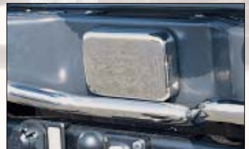
15 Cover for tow bar A vonóhorgot rejtő fedél
