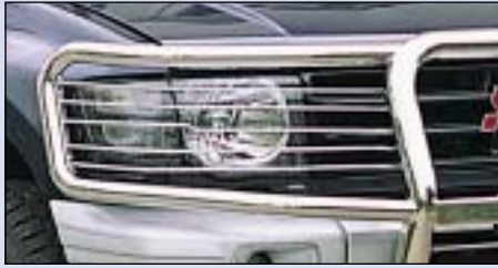
5 Front light protection grille Az első lámpák védőrácsa
