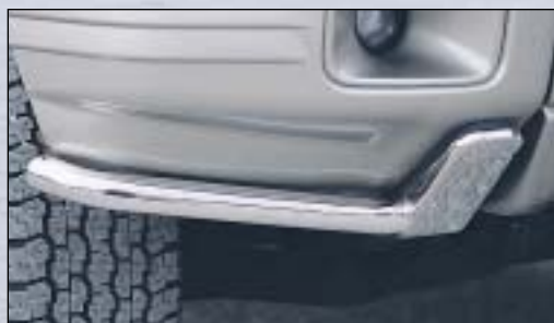
8 Spoiler edge protection with blind Protection de coin du spoiler avec panneau
