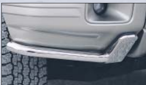
8 Spoiler edge protection with blind spoilerisuojaakulma peitelevyllä
