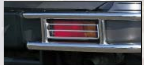
14 Rear light protection grille ochranní mřížka na světlo vzadu
