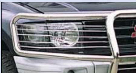
5 Front light protection grille ochranní mřížka na světlo vpředu
