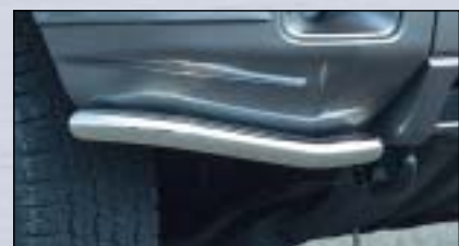
9 Spoiler edge protection ochranný roh na spoiler
