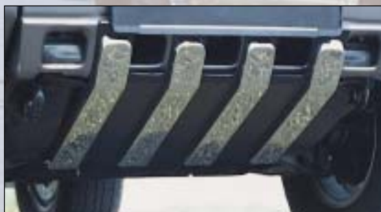
7 Front underride protection spodní ochrana
