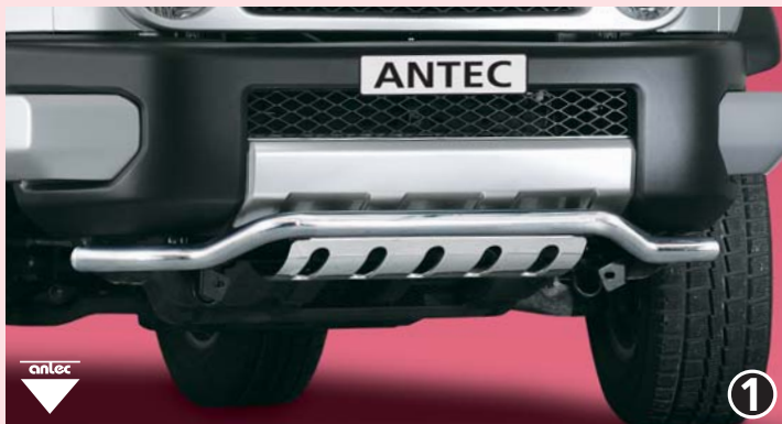
EU-spoiler protection pipe 51mm cranked incl. EU-underride protection plate EU- přední ochranná trubka tvarovaná se spodním chránicem 51mm, Stainless steel / nerezová ocel 12L 4017
