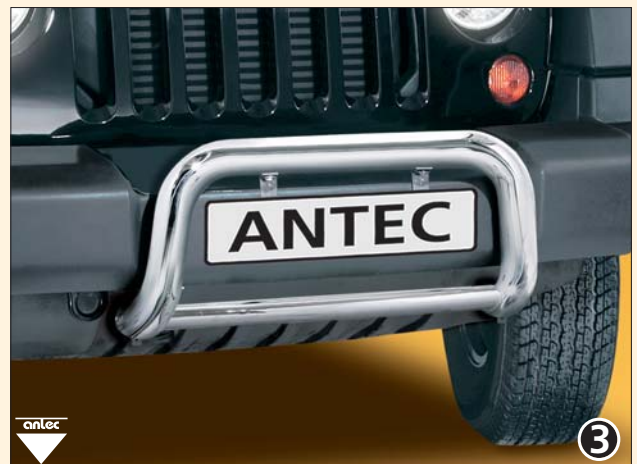
EU-pedestrian protection guard 60mm low with integrated horizontal pipe 42mm (EU-certificate valid also with 12C4088) EU-veiligheidsbeugel voor voetgangers 60mm met geïntegreerde dwarsbuis 42 mm (EU-Zertifikat auch gültig mit 12C4088) Stainless steel / Edellaal 12C 4013
