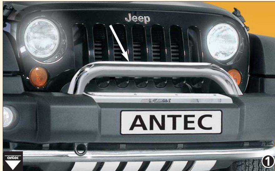
EU-pedestrian protection guard 70mm (EU-certificate valid also with 12C4088; lamp mounting is impossible) EU-személyvédő" cso" 70 mm (Az EU tanúsítvány 12C4088; Montage von Lampen ist nicht möglich) Stainless steel / Inox (rozsdátlan) acél 12C 4113
