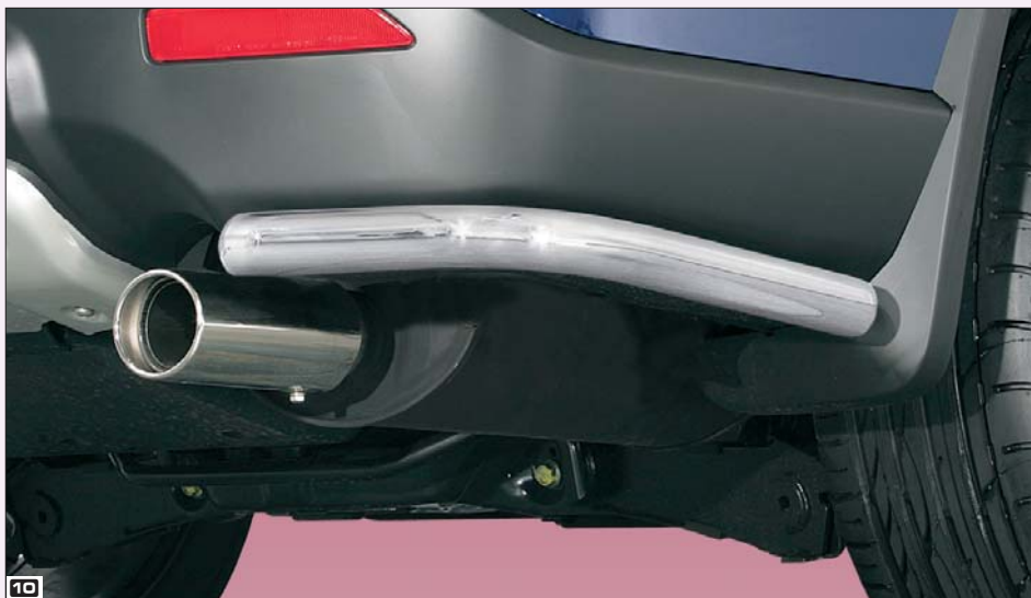
10 Rear bumper protection 42mm single pipe (also mountable with tow-bar) Hoekbeschermer achteraan enkele buis 42 mm (auch montierbar mit Anhängerkupplung) Stainless steel / Edelstaal
