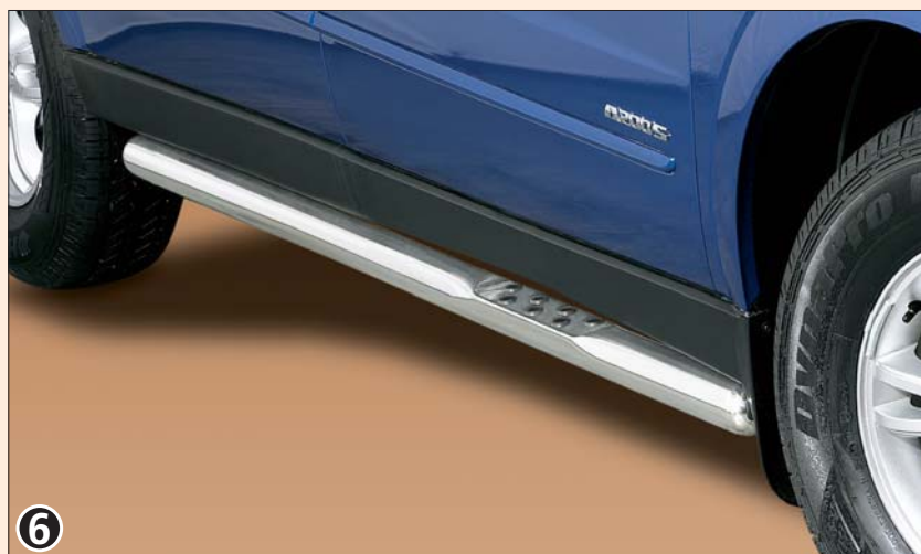
6 Side bar 70mm with one rubber dot step (for SPORTS only) Sidebeskyttelsesrør med trinbræt og skridsikre knopper 70 mm (Kun til SPORTS) Stainless steel / Rustfrit stål 11L 4151
